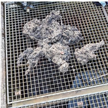
A juste titre et malheureusement, il est nécessaire de le rappeler encore. Dernièrement, la pompe de l'une de nos installations a dû être remplacée prématurément avant la fin de son cycle de vie. Vous pouvez constater les causes de la défaillance sur la base des photos ci-contre.
